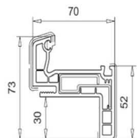
Un sistema dedicato al settore della ristrutturazione. Adatto a tutte le sostituzioni e interventi su vecchi edifici grazie alle alette da 30, 35 o 65 mm il nuovo infisso si adatta ai telai esistenti e si eliminano gli interventi di muratura.
