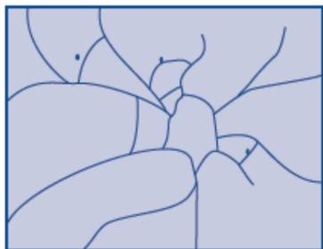
Rys. 53 Uderzenie w powierzchnię szkła (np. rzut kamieniem)
